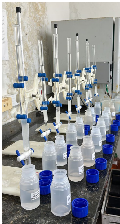
Figura 01. Aparato para extração de elementos metálicos (catiônicos) presentes em água do mar (uma matriz salina próxima ao mineral halita dissolvido).
